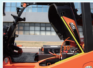
Cofano con apertura a 80° per una manutenzione agevole.
