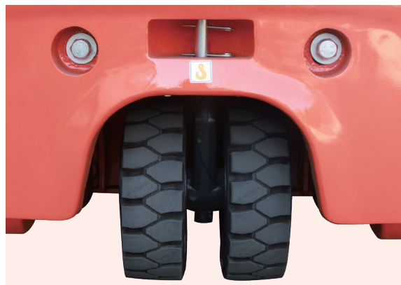
Ruote posteriori maggiorate a pneumatici 140/55-9 per una maggiore capacità di carico.
